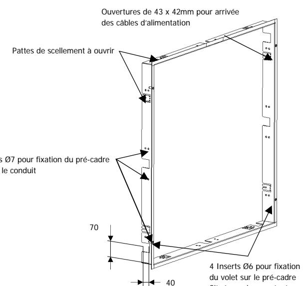
La fixation du pré-cadre doit être réalisée avec soin, en respectant sa géométrie d'origine, c'est-à-dire non voilé et de niveau.
