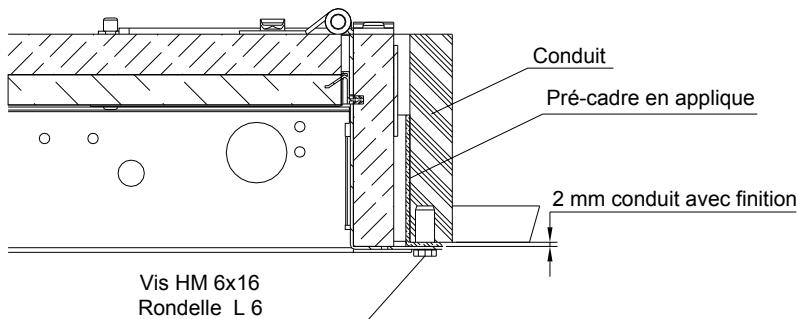
► **MONTAGE CONDUIT BETON POUR VOLET EI60S / EI90S - Cotes de réservation avec précadre.**
