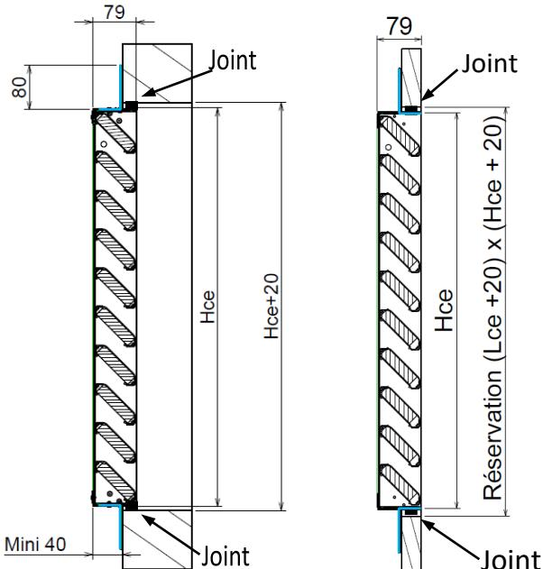
Cornières de fixation, à positionner avec vis autoperceuses sur la grille
