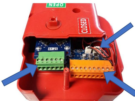
Alimentation électrique du Moteur et de la Bobine
