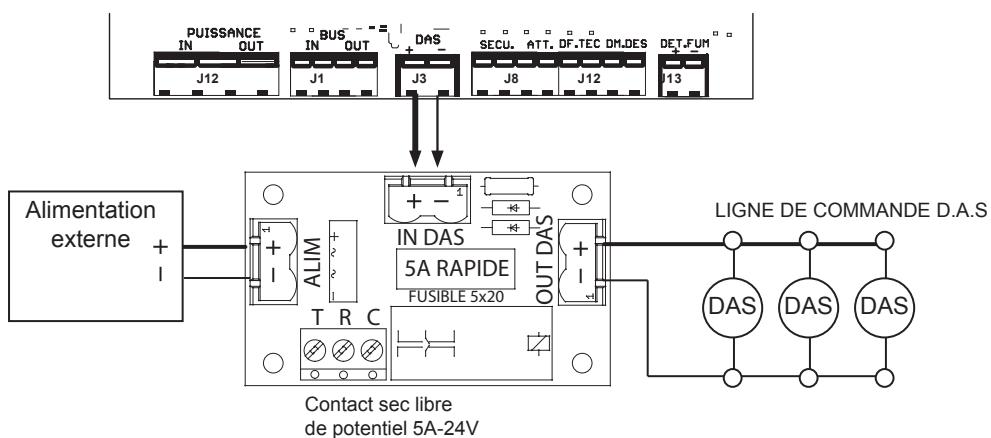
Module interface de Commande DAS à Rupture - BET10-DAS-R
