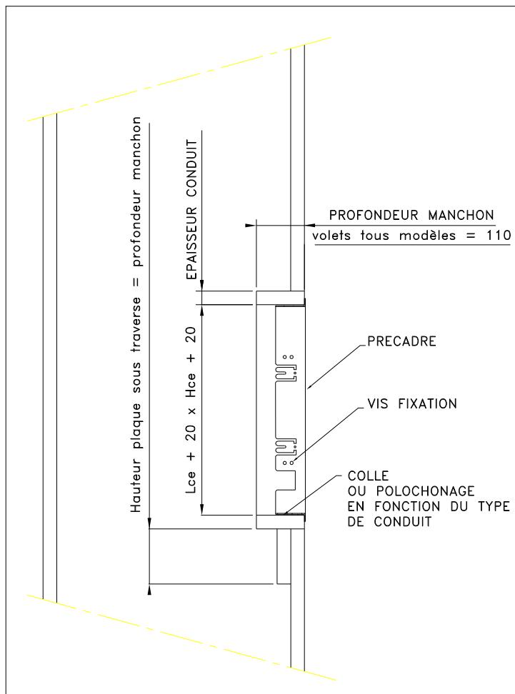
La fixation du pré-cadre doit être réalisée avec soin, en respectant sa géométrie d'origine, c'est-à-dire non voilé et de niveau.
