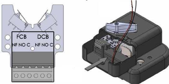
**La carte S 1-25 qui doit être installée de la manière représentée sur le schéma de gauche. L'inscription FDCB doit être visible. Raccorder les contacts NF (Normalement Fermé) – NO (Normalement Ouvert) – C (Commun) pour le DCB (Début de Course Bipolaire) et le FCB (Fin de Course Bipolaire).**
