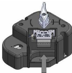
Raccorder les contacts NF (Normalement Fermé) – NO (Normalement Ouvert) – C (Commun) pour le DCU (Début de Course Unipolaire) et le FCU (Fin de Course Unipolaire).
