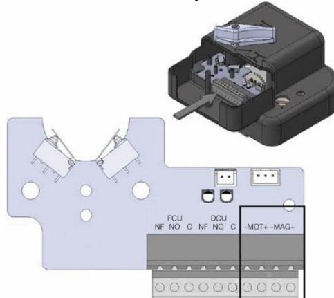
**Raccorder les bornes MAG pour l'alimentation de la bobine et les bornes MOT pour l'alimentation du moteur**
