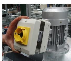
Percer bien au centre l'opercule avec un tournevis cruciforme
